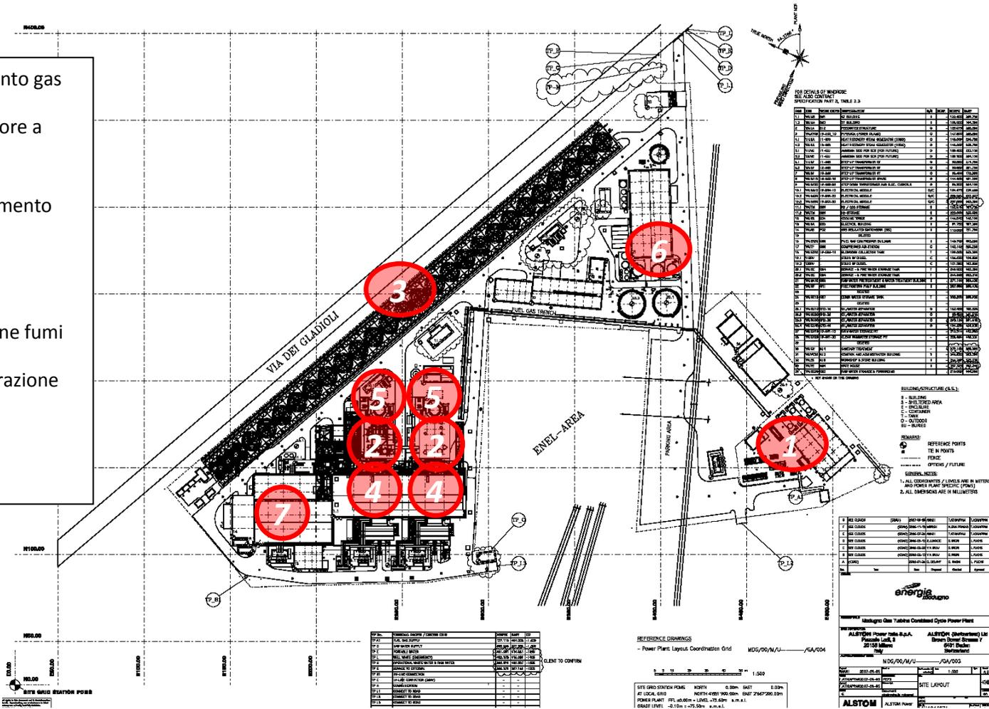
Figura 8: Planimetria generale della centrale di Modugno (in rosso sono cerchiato le ubicazioni dei principali elementi dell'impianto)
